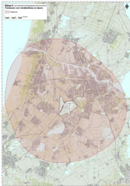
Figuur 6-2: De Outer Horizontal Surface rondom Schiphol geeft een toetsingsvlak voor windturbines aan. (Bron: Luchthavenindelingsbesluit Schiphol) 10
