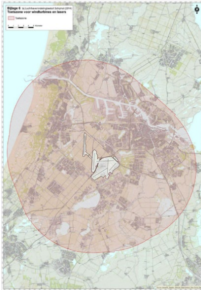
Figuur 2-3: De Outer Horizontal Surface rondom Schiphol geeft een toetsingsvlak voor windturbines aan. (Bron: Luchthavenindeliingsbesluit Schiphol 10 )
