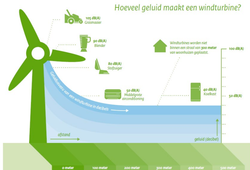
Figuur 2-1: Geluid en windturbines, ter illustratie. (Bron: RVO.nl 4 )
